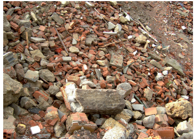
unsortierter, überwiegend mineralischer Bauschutt
